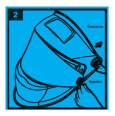
Установите новое поликарбонатное стекло, предварительно удалив защитные пленки стекла. Затем установите крепёж защитного стекла и фиксатор крепежа.
