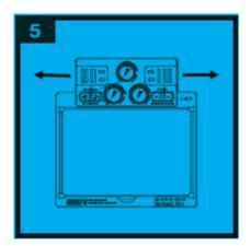
Вытащите крышки батарейных отсеков, находящиеся на верхней части светофильтра. Извлеките элементы питания СR2032. Установите новые элементы питания в такое же положение, как и были установлены, соблюдая полярность. Установите крышки батарейных отсеков на место. ВНИМАНИЕ! Никогда не используйте элементы
