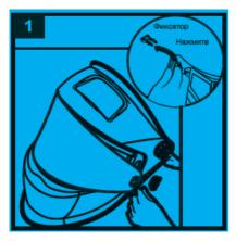
Разблокируйте фиксатор крепежа защитного стекла. Выньте крепёж, затем снимите внешнее защитное стекло.
