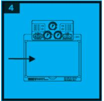
Предварительно удалив защитные пленки с нового стекла, вставьте его в боковые пазы, избегая давления на ЖК панель светофильтра.
