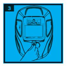
Открутите винт в нижней части рамки крепления светофильтра, расположенной внутри маски. После этого поднимите рамку крепления вверх маски и извлеките светофильтр.
